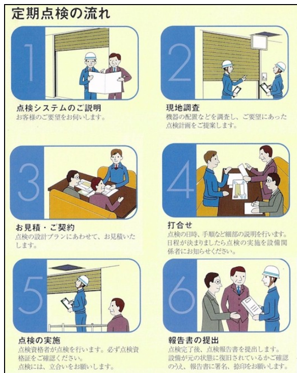
防火シャッターおよび防火扉の点検の種類と期間、定期点検の流れ （日本シャッター・ドア協会「防火シャッター・防火扉・連動制御設備 メンテナンスのすすめ」より）
